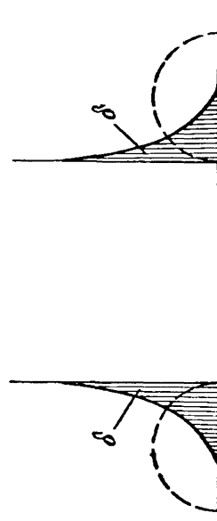
Рис. 12. Катушечный эффект в кольцевом проводнике кругового сечения (кривые дают распределение тока по радиусу сечения кольца).
